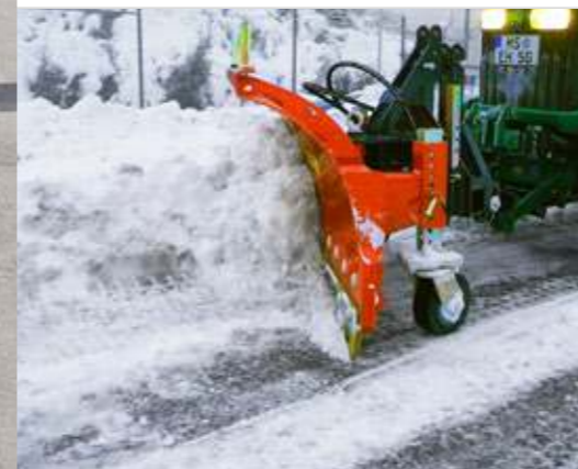
Дъска за снегочистване, дебелина на материала 5-6 мм стоманена плоча
