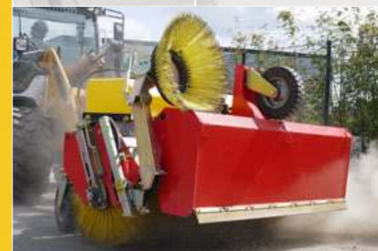
Функция "само метене" и четка с диаметър 750 mm като стандартно оборудване
