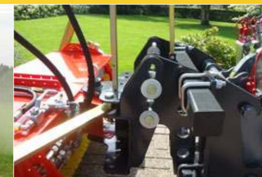
Монтаж на челен товарач с 3D нивелираща система
