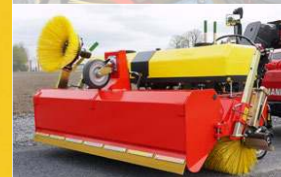
Режим на метене, хидр. система за изпразване на бункера и трето поддържащо колело на бункера
