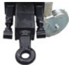
Тежко съединение с регулируема дължина За 1.000, 1.500, 2.000, 3.000 л
